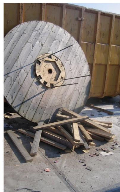
Fig 13 : Villa Welpeloo, Enrouleur de câble démonté pour réutiliser le bois en bardage.
